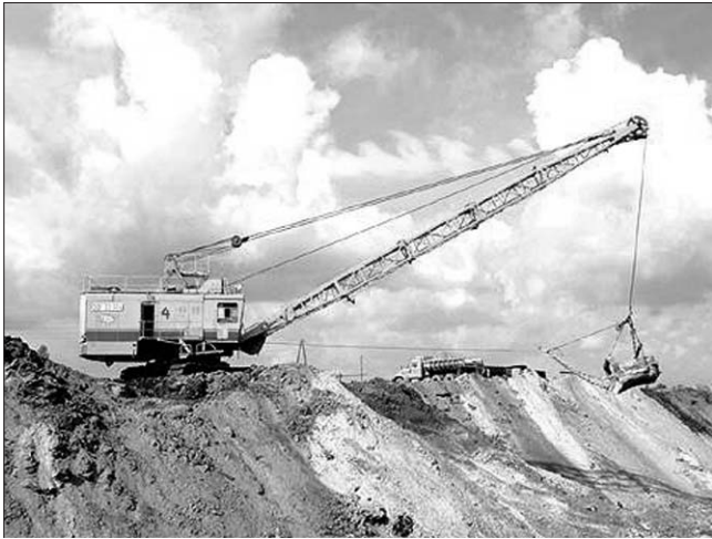
Гусеничный драглайн ЭДГ-3,2.30 пять лет успешно работает на добыче огнеупорной глины в ОАО «Огнеупоры» (г. Богдановичи)
