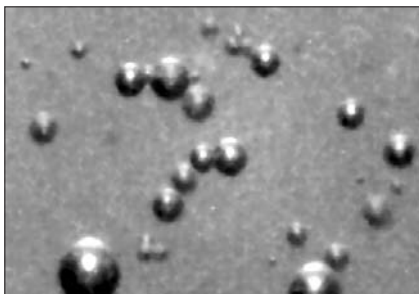
Рис. 1. Линейный кластер из стеклосфер в эпоксидной матрице (×200)
