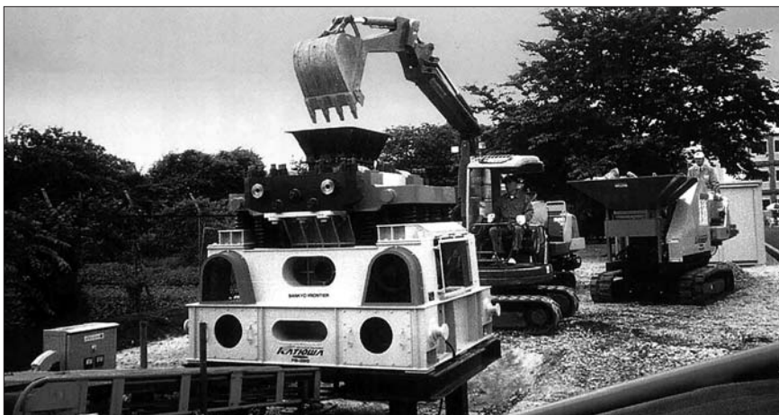
Рис. 2. Вибрационная щековая дробилка (ВЩД) с приемным отверстием 440×800 мм
