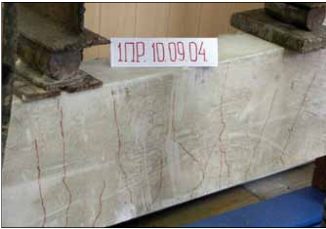
Рис. 1. Испытание фибропенобетонной перемычки, содержащей металлический каркас
