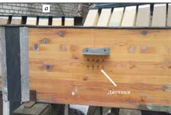
Рис. 7. Изменение влажности древесины клееных элементов в процессе экспонирования на открытом воздухе: а – элемент с датчиками влажности; б – влажность элемента без ЛКП; в – влажность элемента с яхтным лаком Merit jahti. Даты измерения влажности: 2013 г.: 1 – 24.01; 2 – 11.02; 3 – 14.03; 4 – 16.04; 5 – 13.05; 6 – 27.06; 7 – 24.07; 8 – 03.09; 9 – 12.11. 2014 г.: 10 – 10.01; 11 – 25.02; 12 – 14.03; 13 – 01.07; 14 – 29.08
