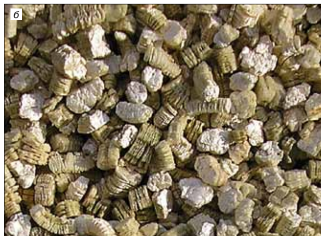
Рис. 1. Компоненты полистирол-вермикулитовых смесей: а – вспененный полистирол (фракция 2–5 мм); б – вспученный вермикулит (фракция 2–5 мм)
