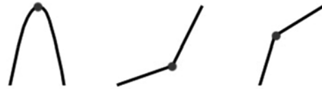
Рис. 5. Варианты расположения точек излома на диаграмме деформации
