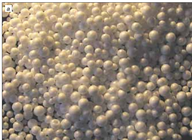
Рис. 1. Компоненты полистирол-вермикулитовых смесей: а – вспененный полистирол (фракция 2–5 мм); б – вспученный вермикулит (фракция 2–5 мм)
