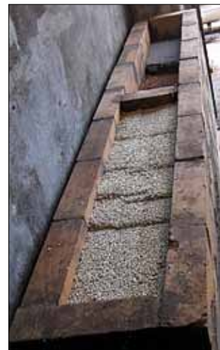
Рис. 6. Уплотненная ПВС на основе ковдорского вермикулита. На заднем плане — уплотненный татарский вермикулит с противопожарной рассечкой
