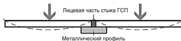
Рис. 2. Прогиб ГСП в ограждающей конструкции
