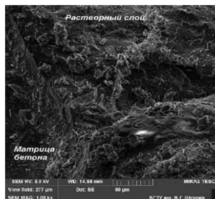
Рис. 4. Микрофотография контактной зоны тяжелый бетон – высокопрочный ремонтный состав (в возрасте 28 сут)
