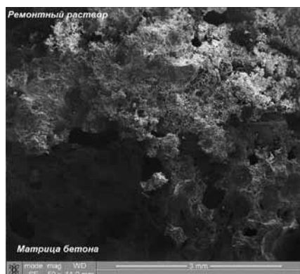
Рис. 2. Микрофотография контактной зоны газобетон – теплоизоляционный раствор (в возрасте 28 сут)
