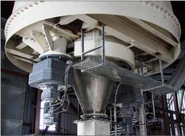
Рис. 4. Механическая выгрузка силоса сырьевого гипса
