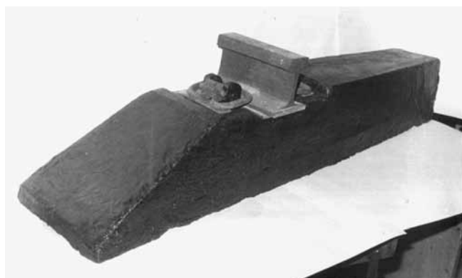
Рис. 2. Фрагмент шпалы из древесно-стекловолокнистого материала
