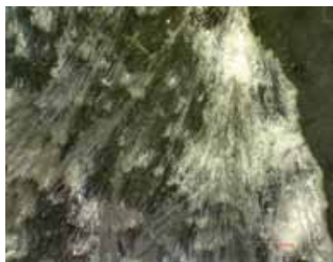
Рис. 4. Кристаллизация этtringита из раствора на стекле
