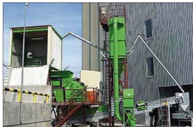
Рис. 3. Дробление и транспортировка сырьевого материала
