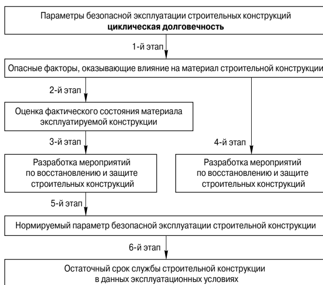
Рис. 1. Основные принципы обеспечения безопасности эксплуатируемых элементов конструкций транспортных сооружений
