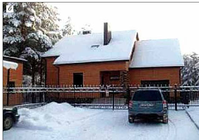
Рис. 4. Главный (а) и дворовый (б) фасады коттеджа в г. Белебее с мансардой, а также с наружными стенами, выполненными в колодезной кладке с применением крупнопористого керамзитобетона
