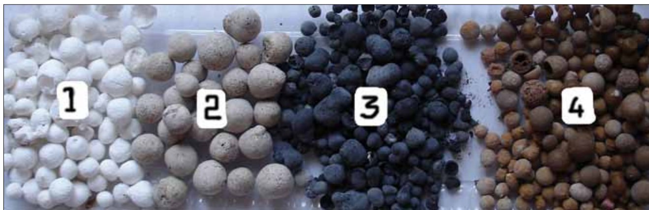
Рис. 3. Различные типы пористых заполнителей на основе модифицированного жидкого стекла. 1 – высокопористый силикатнатриевый заполнитель; 2 – жаростойкий заполнитель с использованием тонкомолотого шамота; 3 – заполнитель с использованием углеотходов Кузбасса; 4 – заполнитель с использованием рядовой невспучивающейся глины
