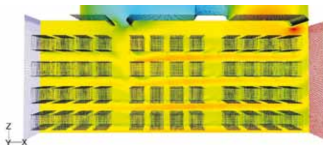
Моделирование распределения скоростей воздуха при полностью сформировавшемся продольном потоке
