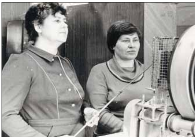
Г.М. Бигильдиева, Л.Д. Антоненко регулируют режим обжига глинозольных гранул
