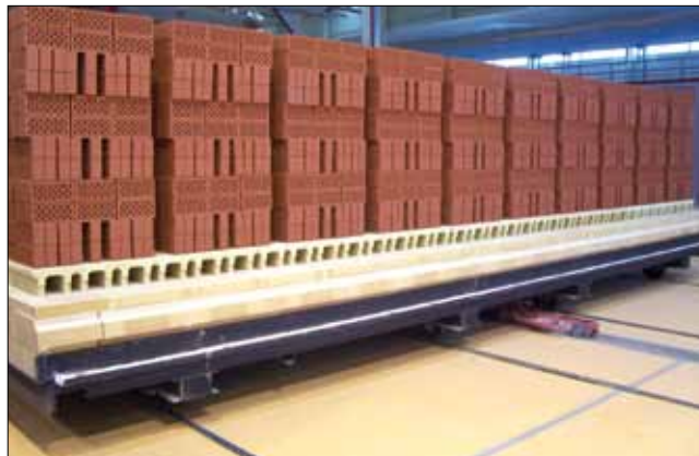
Пример туннельной вагонетки больших размеров. Сорт свода печи: Burton S 60 HD. Стены печи: Burton S 60 T на базе андалузита, устойчивый против соединений щелочных оксидов
