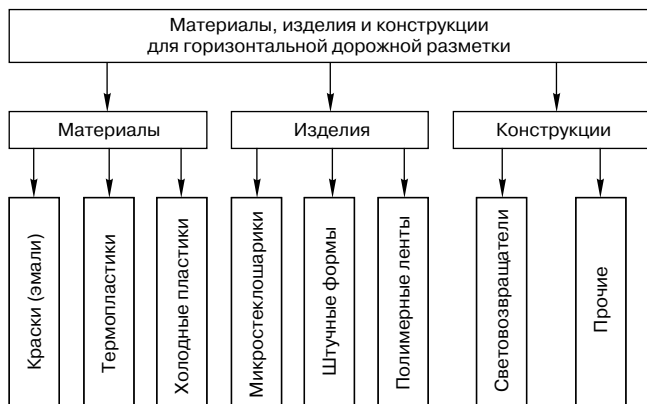
Классификация материалов, изделий и конструкций для горизонтальной дорожной разметки
