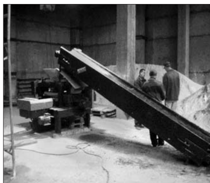
Рис. 4. Общий вид установки РК-250 для прессования стеновых и перегородочных блоков на основе фосфогипса и шлакового вяжущего
