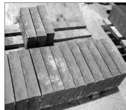
Рис. 6. Отформованные гипсошлаковые блоки 90×190×390 мм
