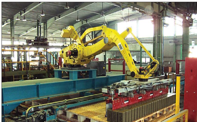
Осуществление загрузки вагонетки с помощью робота
