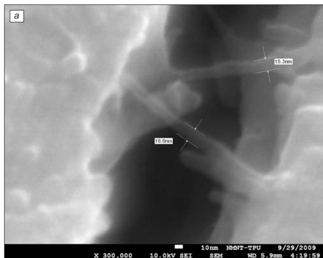
Рис. 3. Углеродные нанотрубки на подложке в разрывах пленки поверхностно-активного вещества после его высыхания и усадки: а – нанотрубки, не покрытые слоем ПАВ; б – с покрытием слоем ПАВ
