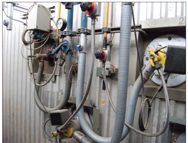
Распределение имеющихся высокоскоростных горелок и дополнительно установленных высокоскоростных горелок фирмы «ЛИНГЛ»
