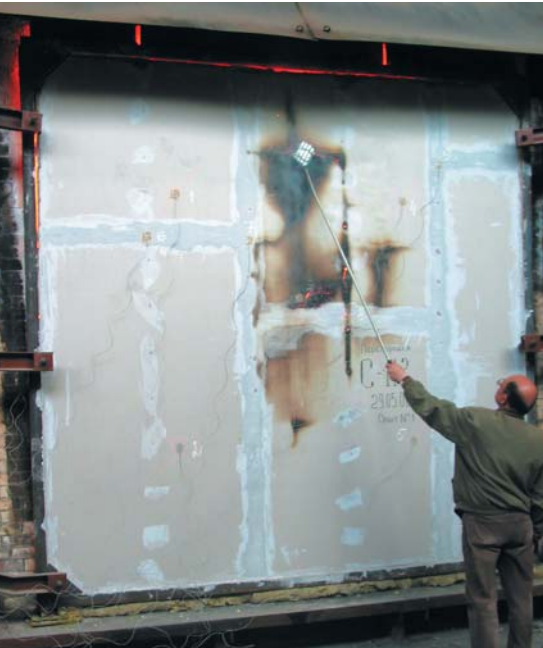
Перегородка С 111 через 1 час огневых испытаний
