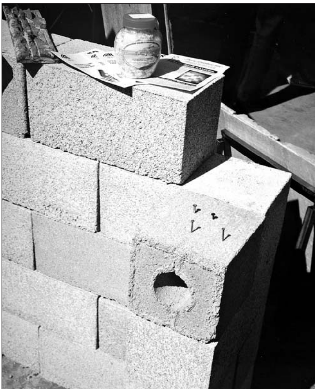
Стеновые блоки «Древолит» на основе магнезиального вяжущего характеризуются хорошими теплосберегающими характеристиками, обеспечивают благоприятный микроклимат помещений, поддаются обработке традиционными режущими инструментами
