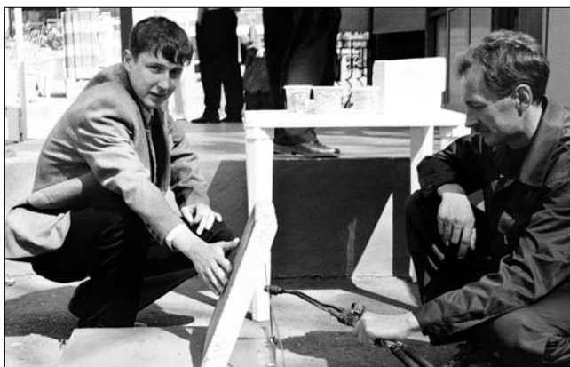
Высокие теплоизоляционные свойства плит «Вермикулит» демонстрировали с применением ацетиленовой горелки на открытой площадке специалисты фирмы «Вермистройиндустрия»
