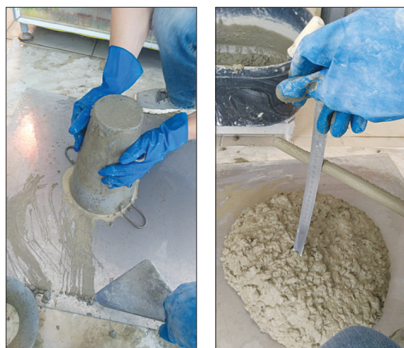
Рис. 2. Определение удобоукладываемости бетонной смеси по осадке конуса
