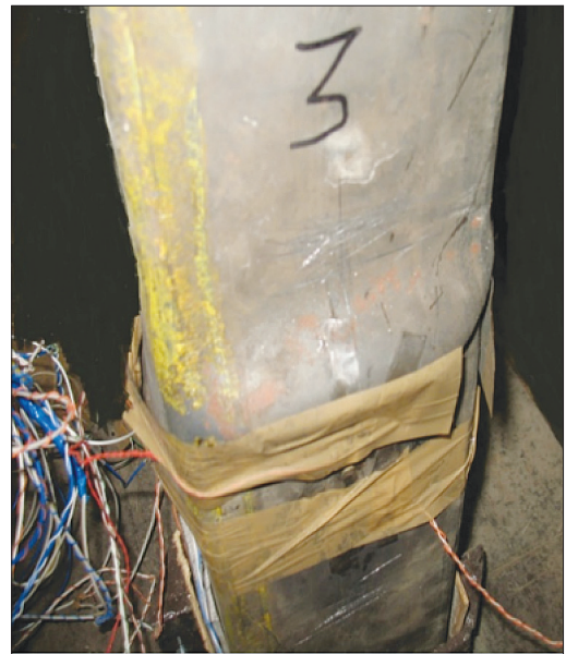
Рис. 4. Характер разрушения образцов серии ТБС.40
