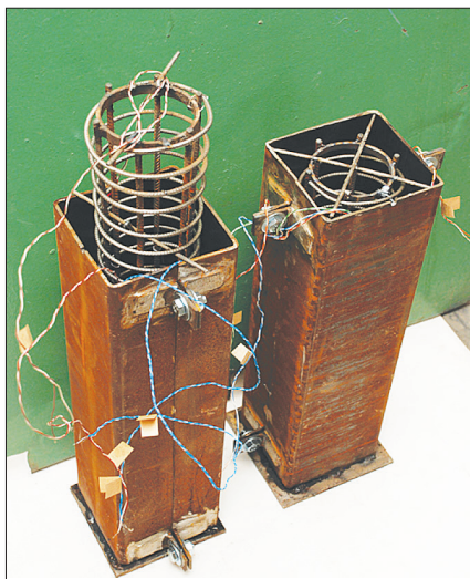
Рис. 1. Установка арматурного каркаса в образцы серии ТБС.40
