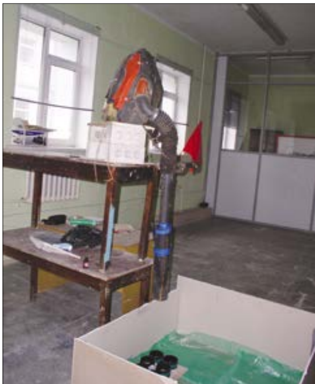
Рис. 1. Установка Husqvarna производительностью 780 м 3 /ч с устройством для боковой загрузки материала на шланге
