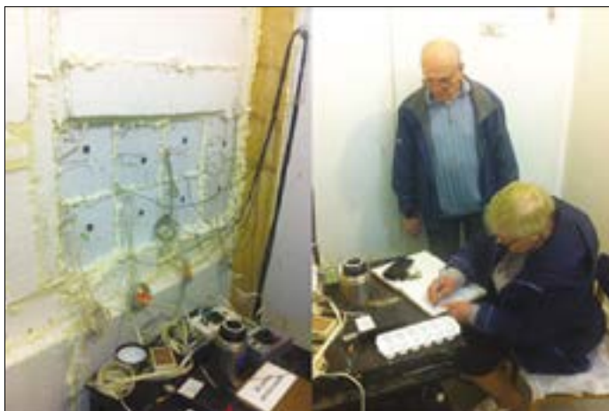
Рис. 4. Испытания опытных образцов сэндвич-панелей в климатической камере проводят главный метролог НИИСФ РААСН Г.А. Потапова и д-р техн. наук А.М. Цирлин ИПС им. А.К. Айламазяна РАН
