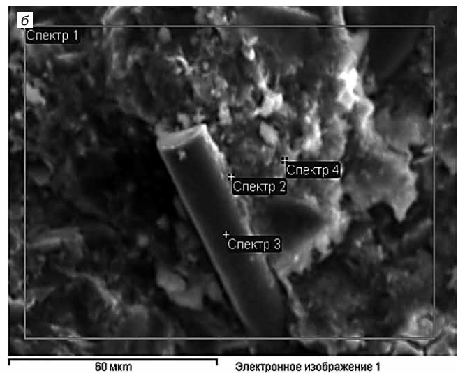
Рис. 2. Микроструктура базальтофиброцементных композиций: а – ПЦ+БВ (4%); б – ПЦ+БВ (4%)+Таркосил®-05 (0,5%)
