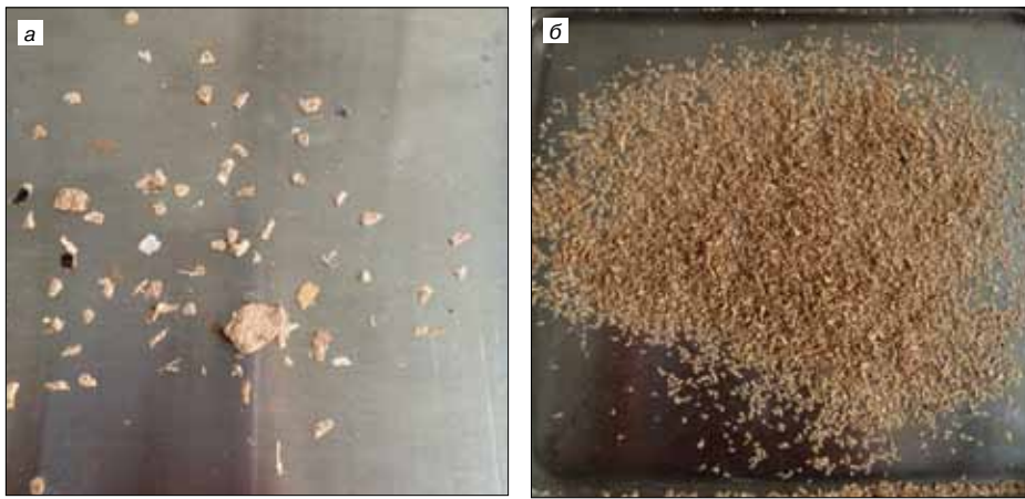
Рис. 1. Внешний вид остатка при просеивании ДО на ситах № 063 (а) и № 0315 (б)
