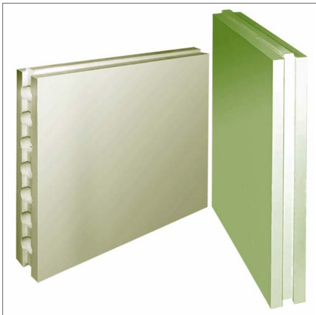
Рис. 1. Пустотелые ВОЛМА-плиты изготавливают из гипсового вяжущего с добавлением пластифицирующих и гидрофобных добавок по литьевой технологии. Плита имеет паз и гребень на опорной и стыковочной поверхностях, а также внутренние продольные пустоты диаметром 40 мм. Влагостойкие плиты выполнены с маркировочной подкраской зеленоватого оттенка. Размеры плиты 667×500×80 мм, масса 20–22 кг
