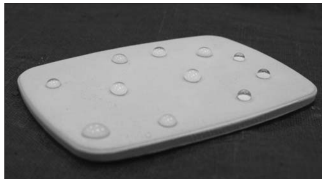
Рис. 2. Капли воды на поверхности гипсовой пластинки, гидрофобизированной составом «Неогард-2» после изготовления
