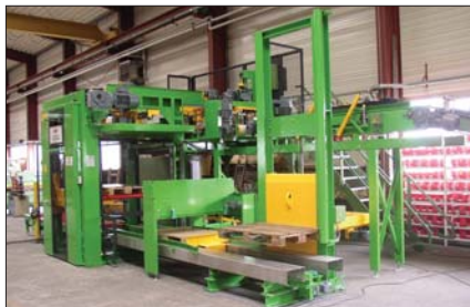
Рис. 9. Укладчик на поддоны с магазином для пустых поддонов и транспортером мешков
