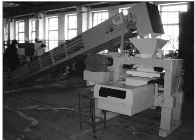
Рис. 7. Установка для прессования изделия гипсовых блоков на базе ПК-250
