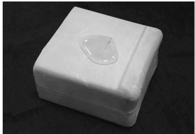
Рис. 3. Вода на поверхности гипсового блока, изготовленного с использованием состава «Неогард-гипс-0.2»
