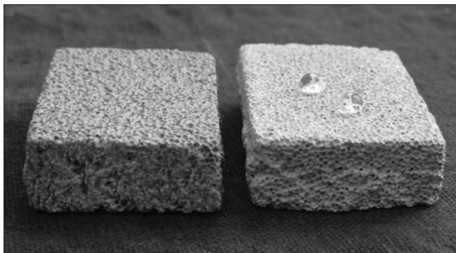
Рис. 1. Гидрофобизированный и негидрофобизированный пенобетон после извлечения из воды
