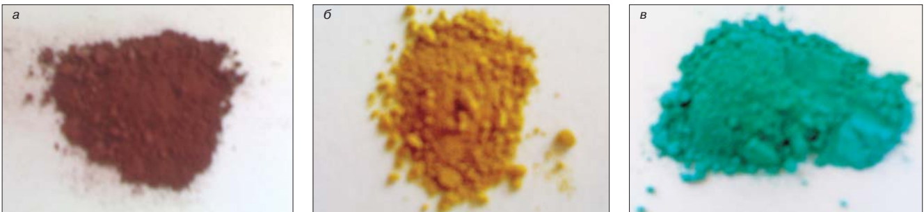
Рис. 4. Образцы анортозита, окрашенные в твердофазном режиме: а – 30 мас. % железистоокисный пигмент марки К-1; б – 10 мас. % К-1; в – 0,5 мас. % фталоцианиновый зеленый
