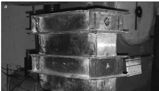
Рис. 5. Пресс-формы для изготовления гипсовых перегородочных изделий 120×190×590 мм: а – в сборе; б – вид сверху
