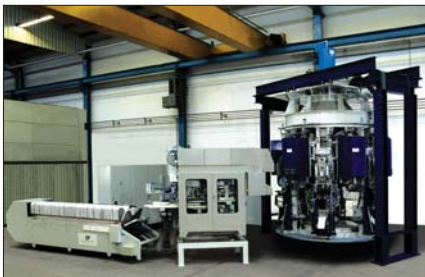
Рис. 8. Карусельная упаковочная машина с автоматическим мешконасадчиком и кассетным магазином
