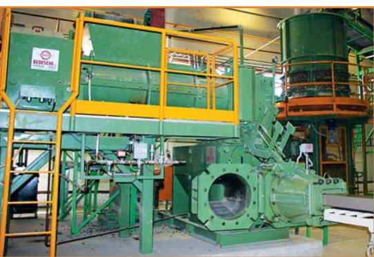
В технологической линии установлен пресс итальянской фирмы «Бедески»
