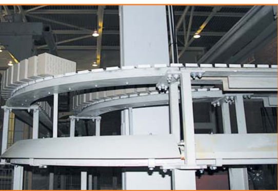
По транспортному конвейеру высушенный кирпич-сырец направляется к автомату-садчику
