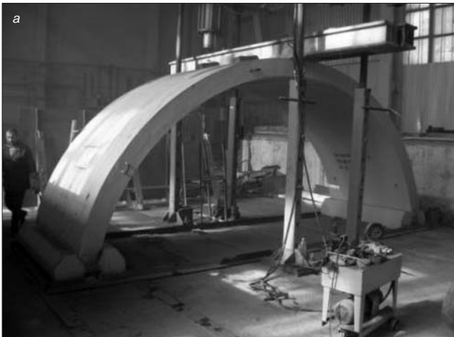
Рис. 4. Испытания сталефибробетонных конструкций на испытательном стенде БашНИИСтрой: а – трехшарнирная арка пролетом 6 м; б – водопропускная труба диаметром 1,5 м
