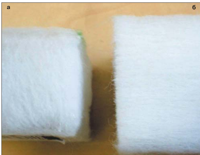
Рис. 2. Внутренняя структура изделий отличается расположением волокон: вертикальным (а) или горизонтальным (б)
