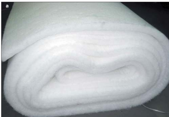
Рис. 1. Теплоизоляция КипТек может производиться в виде матов (а) и плит (б)
