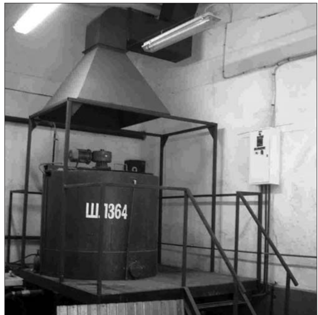
Рис. 1. Установка ШЛ-364 для производства белкового пенообразователя «Омпор»
