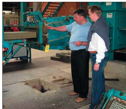
«Чтобы выпускать более ста наименований керамической продукции необходимо иметь парк быстро сменяемых мунштуков» – поясняет технический директор ЗАО «Победа ЛСР» А.В. Гаврилов (слева) коммерческому директору В.А. Дырдасову
