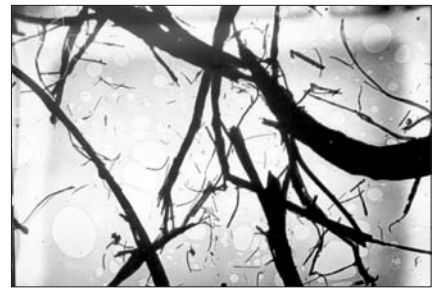
Рис. 3. Продукты кислотной обработки натурального хризотил-асбеста
