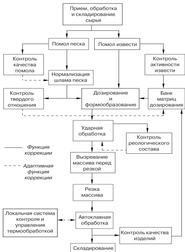
Рис.2. Схема адаптивного ведения технологического процесса
