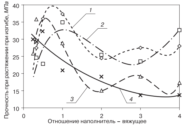
Рис. 2. Зависимость изменения прочности при сжатии и при растяжении и изгибе эпоксидно-каменноугольных композитов от содержания и дисперсности наполнителя: 1 – фракция наполнителя < 0,071 мм; 2 – фракция 0,071–0,14; 3 – фракция 0,14–0,315; 4 – фракция 0,315–0,63
