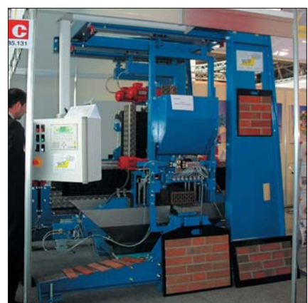
На Ceramitec-2006 немецкая фирма W+K Maschinenfabrik GmbH впервые представила машину для текстурирования граней керамического кирпича модульной конструкции, которая легко встраивается в существующие производства
