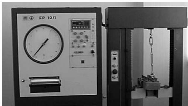
Рис. 4. Определение адгезионного коэффициента
