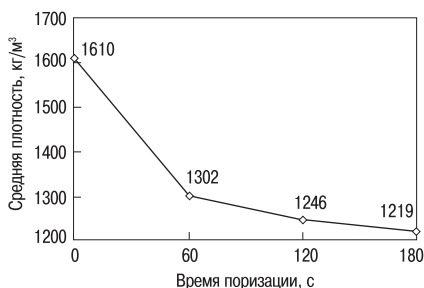
Рис. 1. График зависимости средней плотности затвердевшего раствора от времени поризации смеси
