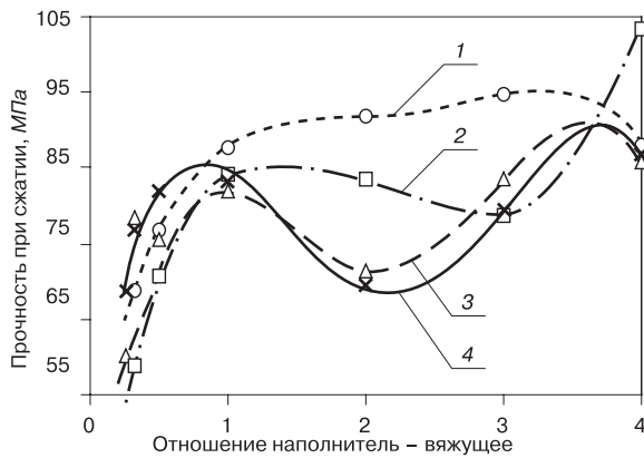
Рис. 2. Зависимость изменения прочности при сжатии и при растяжении и изгибе эпоксидно-каменноугольных композитов от содержания и дисперсности наполнителя: 1 – фракция наполнителя < 0,071 мм; 2 – фракция 0,071–0,14; 3 – фракция 0,14–0,315; 4 – фракция 0,315–0,63
