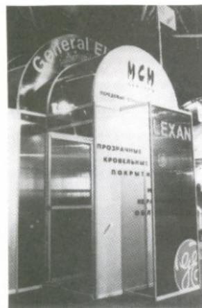
**Рис. 8.** Применение многослойных ударопрочных пластин из поликарбоната Lexan позволяет реализовать интересные архитектурные решения. Изготовитель данного пластикового материала — американская фирма «General Electric Plastics».
