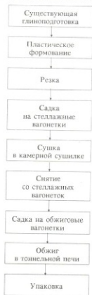
Рис. 1. Блок-схема заводов пластического формования с сушкой на стеллажных вагонетках до реконструкции
