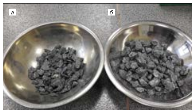
Рис. 4. Внешний вид щебня фракции 10–20 мм из габбро-диабазы, полученного с использованием дробилок ДЩ 100×200 (а) и 2ЩДС 100×200 (б)
