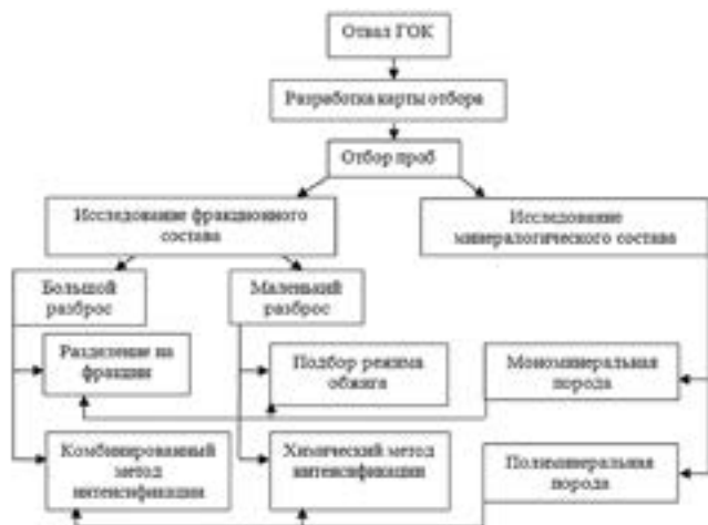
Рис. 1. Методологическая схема назначения технологии производства вяжущих из магнезиальных отходов ГОК
