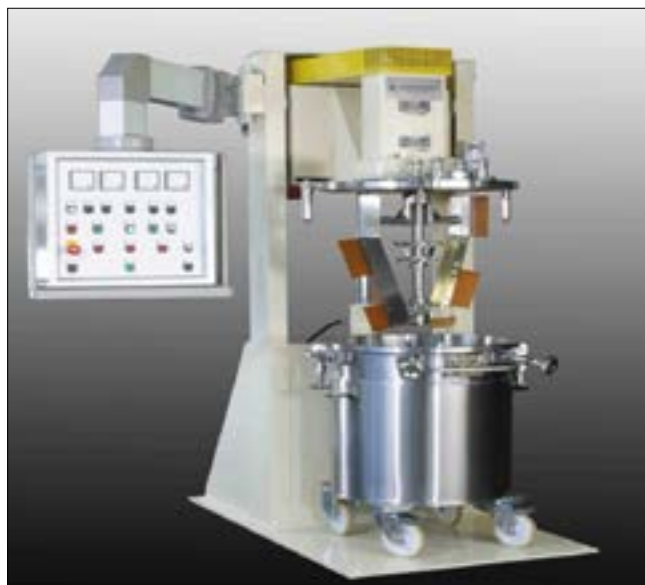
Рис. 2. Экспериментальный смеситель объемом 100 л
