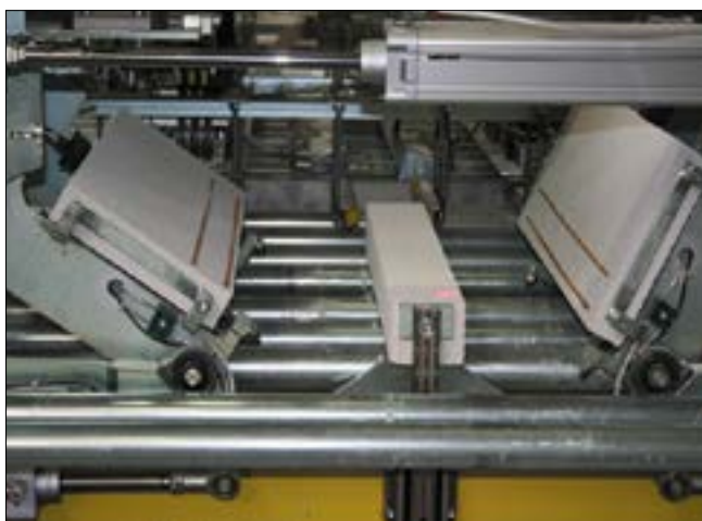
Плиты склеиваются в форме прочной U-образной перемычки специальным клеем
