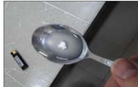
Рис. 3. Конкурентный поликарбоксилатный пластификатор через 30 с нагрева
