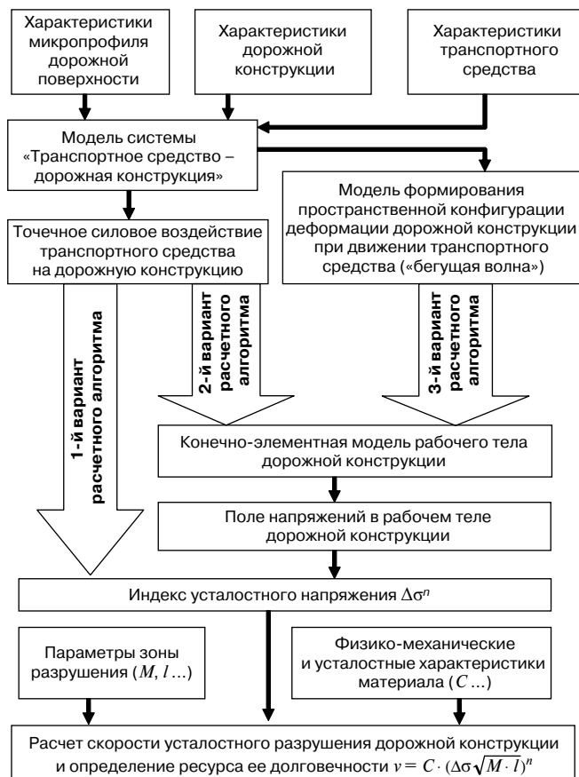
Рис. 3. Рабочая схема связи элементов вычислительного алгоритма для анализа долговечности дорожной конструкции
