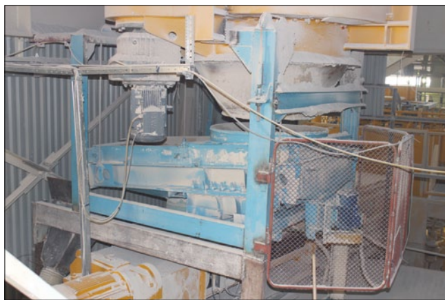
Рис. 1. Сортировка С-1-1000, установленная после реактора
