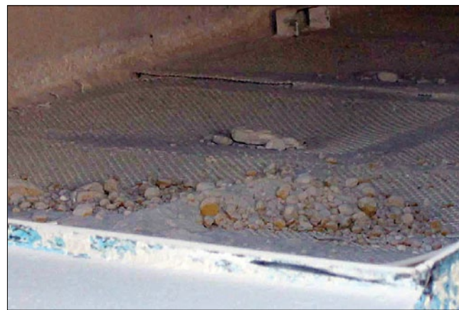
Рис. 2. Окатыши и посторонние примеси крупностью более 5 мм на ситовой поверхности грохота
