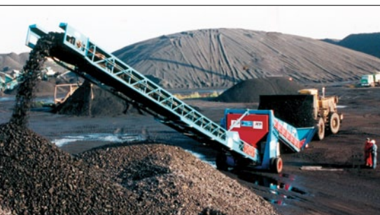
Рис. 13. Установка Stormajor объединяет в себе преимущества питателя SAMSON с отвалообразователем радиального действия
