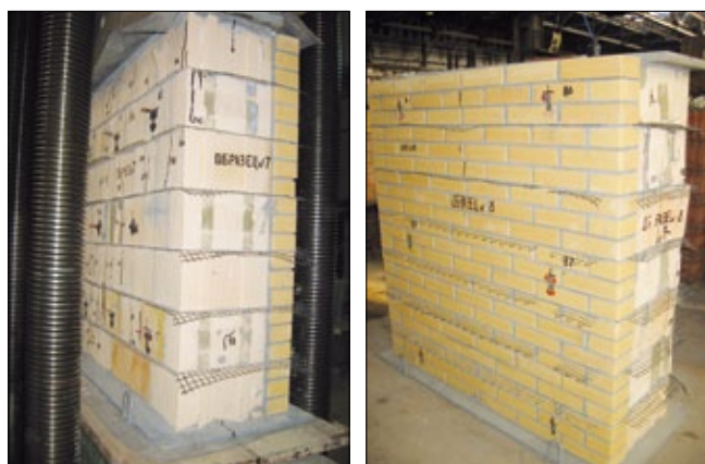
Рис. 4. Образцы кладки 3-й серии из крупноформатных камней, облицованные кирпичом, после испытаний
