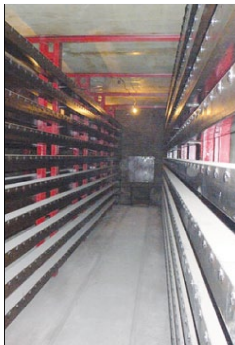
Рис. 1. Транспортные механизмы загрузки/выгрузки и расположение кирпича в сушильной камере на рядке
