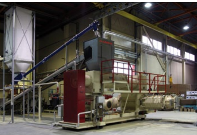
Линия А. Участок формования с круговым глинорастирателем BRSH 19b на заднем плане и вакуумный экструдер Futura II Type E65a/ 56/ MDVG 1025f
