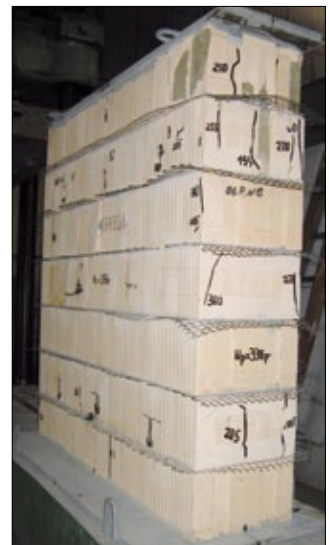
Рис. 3. Образец кладки 2-й серии из крупноформатных камней, армированный сетками, после испытаний
