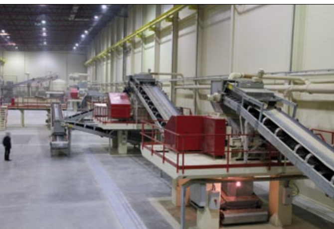
Линия А на заднем плане: бегуны и валки тонкого помола. На переднем плане: линия Б
