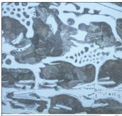
Рис. 1. Микроструктура бандажа исполнения ТШХНМ-70, x500
