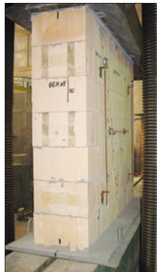
Рис. 2. Образец кладки из крупноформатных камней во время испытаний
