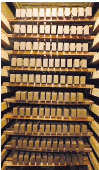
Рис. 1. Транспортные механизмы загрузки/выгрузки и расположение кирпича в сушильной камере на рядке
