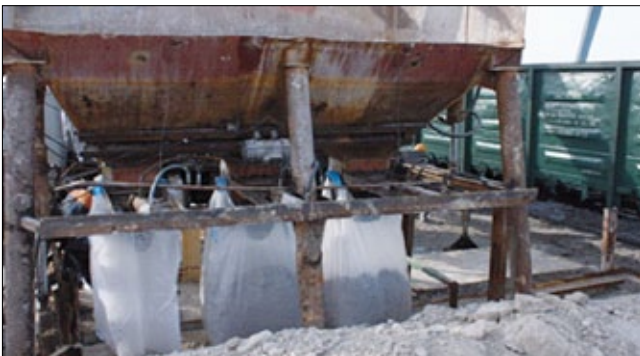
Бункерный механизм для погрузки глины в одноразовую тару МКР
