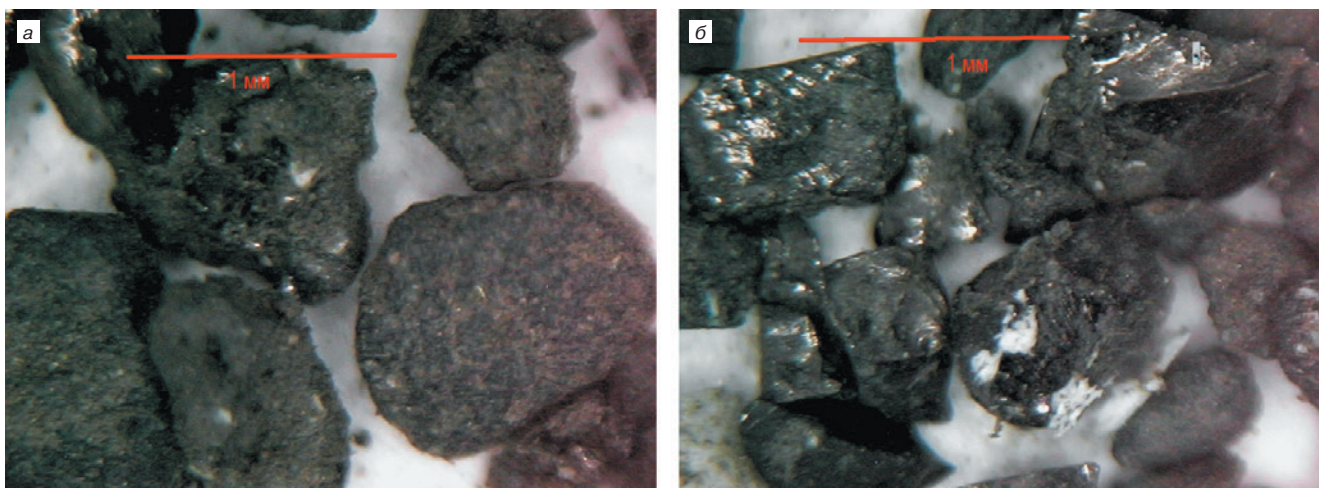
Рис. 2. Сростки частиц угля с вмещающими породами фракции 0, 63–1,25 (а) и частицы чистого угля фракции 0,315–0,63 мм (б)
