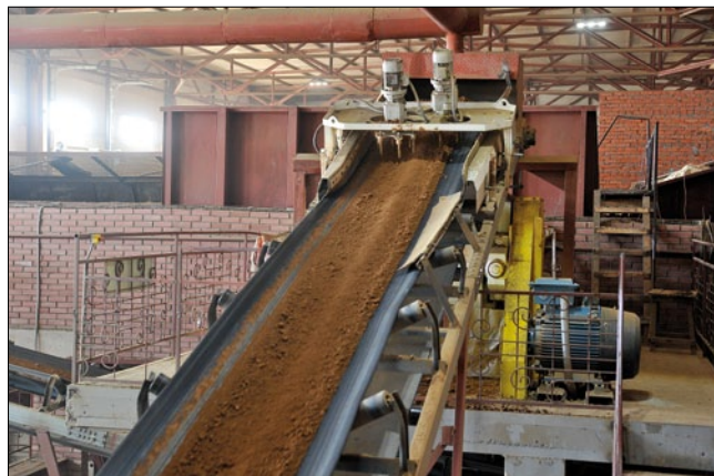
В целях унификации для грубого и тонкого помола используются вальцы с гидравлическим прижимом одной и той же модели, с шириной валков 800 мм
