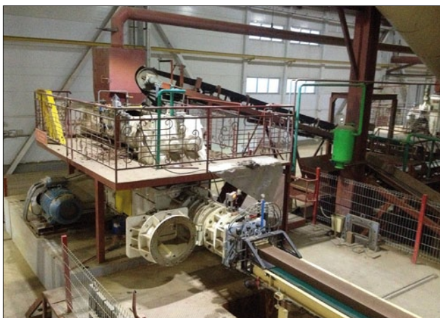
Шнековый вакуумный пресс оснащен двумя шарнирно-откидными головными частями, позволяющими производить керамические стеновые материалы в широком диапазоне форматов
