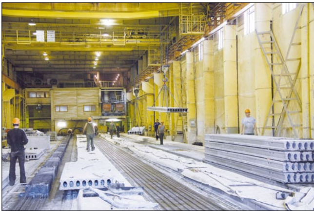
Рис. 3. Цех производства на «длинных» стендах предварительно напряженных многопустотных панелей перекрытий из керамзитобетона классов по прочности В20–В22,5 по технологии стендового безопалубочного формования на заводе КПД Томского ДСК (2009 г.)
