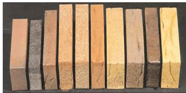
Рис. 3. Увеличение поверхности лицевых граней кирпича после обработки в рустикаторе облегчает сушку сырца и маскирует дефекты внешнего вида
