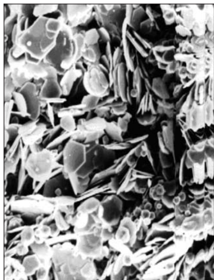
Рис. 1. Электронно-микроскопическое изображение поверхности гидратированного C_3A ( \times 3000 )
