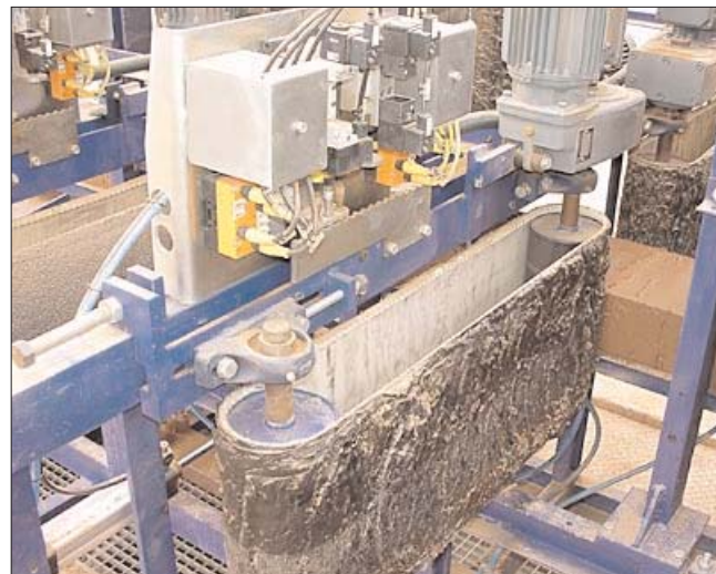
Рис. 2. Рустикатор R06 для декоративной обработки экструдированного глиняного бруса
