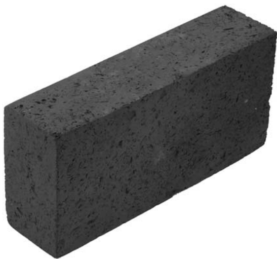
Рис. 1. Поризованный кирпич с содержанием опилок 20 мас. %
