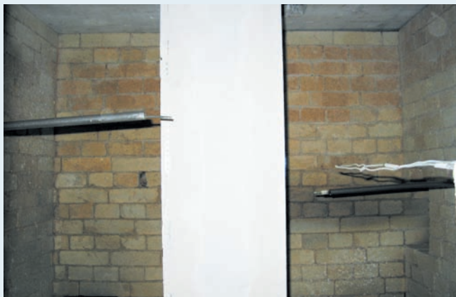
Рис. 3. Колонна с бескаркасной огнезащитной облицовкой в камере для испытаний на огнестойкость
