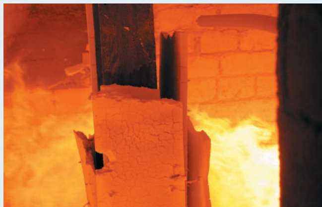
Рис. 4. Колонна с бескаркасной облицовкой через 161 мин огневых испытаний
