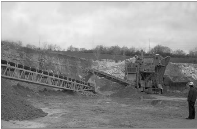
Рис. 2. Карьер Марбл-Клиф после реконструкции: а – самоходный дробильный агрегат; б – линия конвейеров (фото автора)
