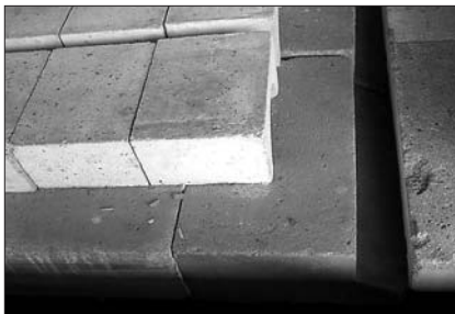
Рис.2. Внешний вид футеровки печного вагона после 400 циклов работы
