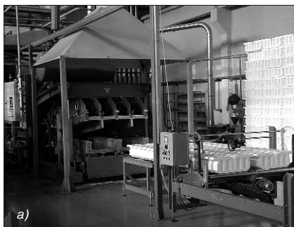
Рис. 2. Производство оставляемой опалубки Пластбау: а) – межэтажных перекрытий; б) – внутренней и внешней сторон конструкции; в) – линия сборки стеновых элементов
