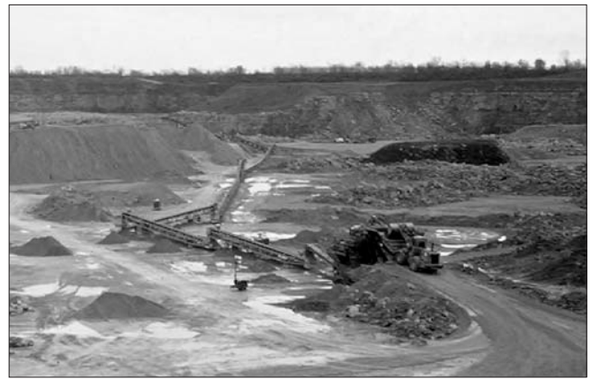
Рис. 2. Карьер Марбл-Клиф после реконструкции: а – самоходный дробильный агрегат; б – линия конвейеров (фото автора)
