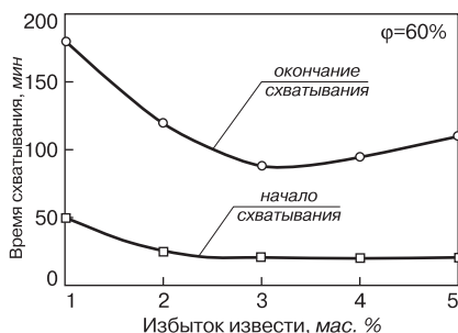
Рис. 3. Влияние избытка негашеной извести (СаО) на время схватывания фторангидритовых образцов
