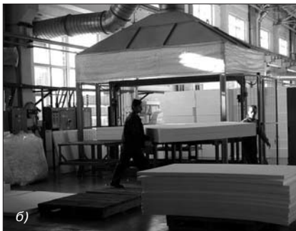
Рис. 2. Производство оставляемой опалубки Пластбау: а) – межэтажных перекрытий; б) – внутренней и внешней сторон конструкции; в) – линия сборки стеновых элементов
