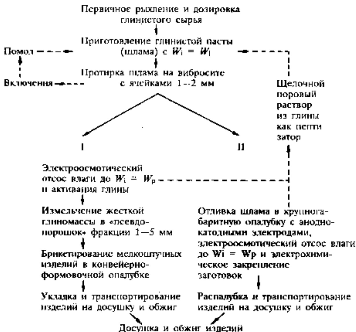
Рис. 1. Упрощение принципиальной блок-схемы переработки глин в крупногабаритные элементы (фрагмент II — справа) по сравнению со схемой-аналогом изготовления мелкоштучных изделий (фрагмент I — слева), где W_1 и W_p означают соответственно верхний и нижний пределы пластичности (границы текучести и раскатывания) используемого глинистого сырья
