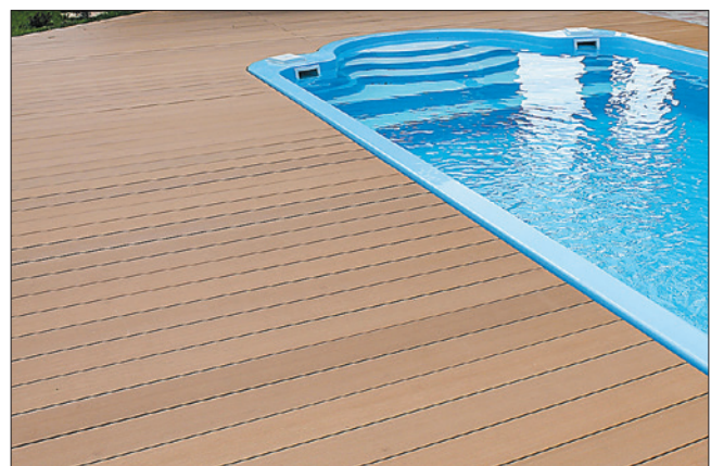
Рис. 6. Внешний вид ДПК после 12 недель экспозиции в уличных условиях
