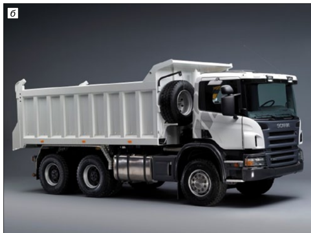
Рис. 1. Типы грузового транспорта 70-х гг. и в настоящее время: а – грузоподъемность автомобиля КАМАЗ 10 т; б – автомобиль SCANIA грузоподъемностью 25 т
