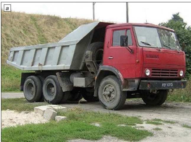
Рис. 1. Типы грузового транспорта 70-х гг. и в настоящее время: а – грузоподъемность автомобиля КАМАЗ 10 т; б – автомобиль SCANIA грузоподъемностью 25 т
