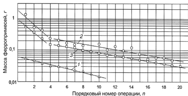
Рис. 1. Массы осадка, выделенного из кварцевого песка (1), двух проб полевого шпата (2 и 3) в каждой операции магнитоконтроля
