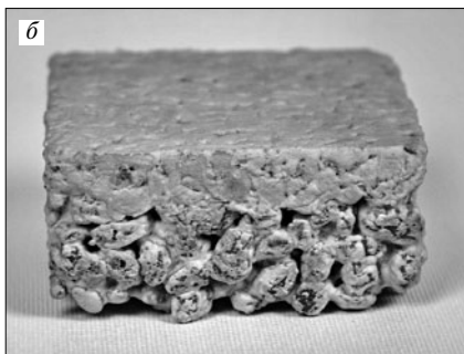
Рис. 2. Материал крупнопористой структуры с керамзитом фракции 10–20 мм (а) и двухслойного поперечного сечения с керамзитом фракции 5–10 мм (б)
