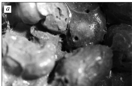
Рис. 1. Фрагменты материала после обжига без вспучивания (а) и со вспучиванием (б) стеклообразного связующего
