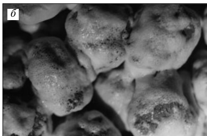
Рис. 1. Фрагменты материала после обжига без вспучивания (а) и со вспучиванием (б) стеклообразного связующего
