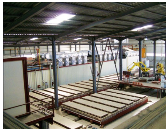
Роботизированный разгрузчик укладывает кирпичи на паллеты (проект Amouri)
