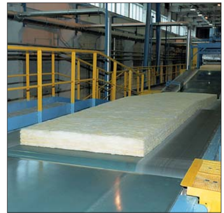
Рис. 3. В 2005 г. завод «Сан-Гобэн ИзOVER» в г. Егорьевске (Московская обл.) начал выпускать теплоизоляционные материалы нового поколения из стекловолокна
