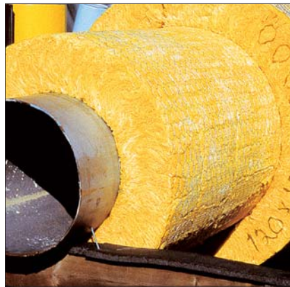
Рис. 2. Прошивные теплоизоляционные маты ISOTEC KVM-50 гофрированной структуры с преимущественно вертикальной ориентацией волокон
