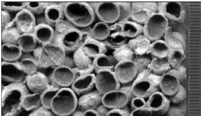
Рис. 2. Зернистая омоноличенная структура теплоизоляционного материала (цена деления 1 мм)
