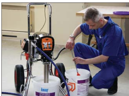
Достаточно открыть ведро, установить его на машину, и можно шпаклевать...
