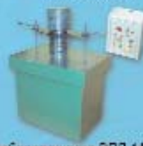
Виброплощадка ВПП-1АВ для формирования асфальтобетонных образцов
