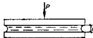
Рис. 3. Прослойка воды между гидрофильными поверхностями
