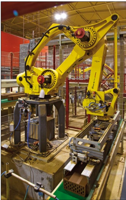
Передающий робот с грейфером для захвата мерного бруса
