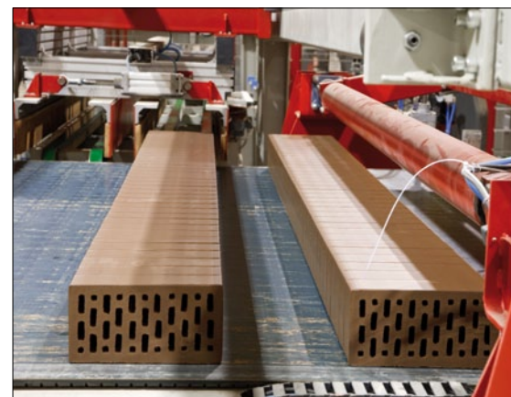
Детальный вид резака (проталкиванием) с устройством для снятия фаски
