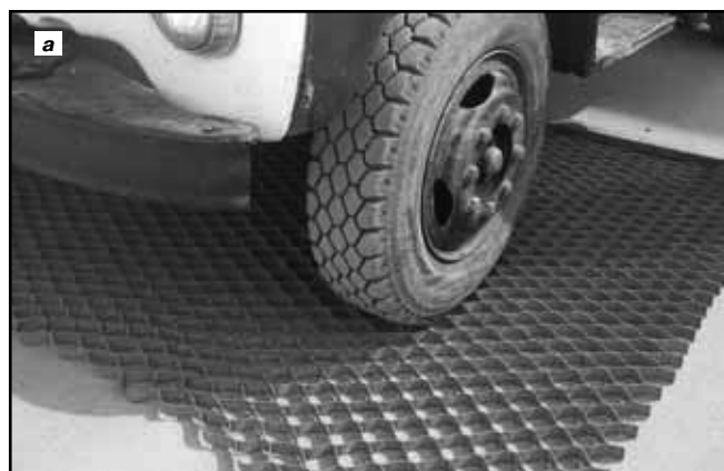
Рис. 2. Внешний вид экопаркинга: а — испытание георешетки экопаркинга; б — окончательный вид экопаркинга
