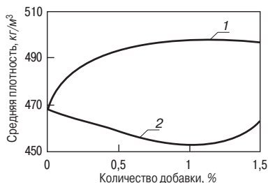
Рис. 4. Зависимость плотности поробетона от концентрации кальциевой и натриевой солей: 1 – кальциевая соль; 2 – натриевая соль
