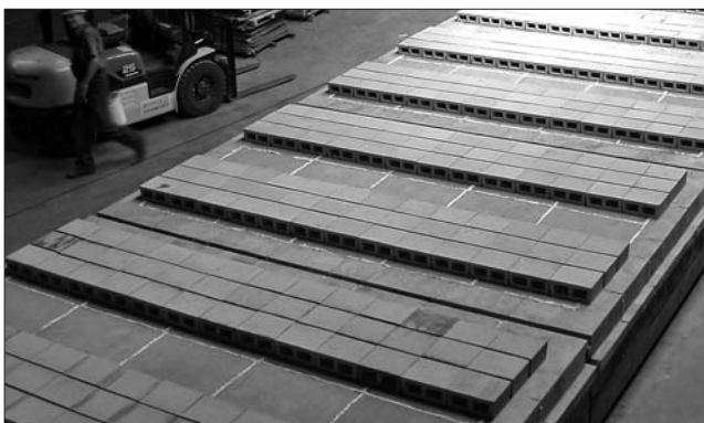
Рис. 3. Общий вид футеровки печных вагонеток из алюмосиликатного керамобетона
