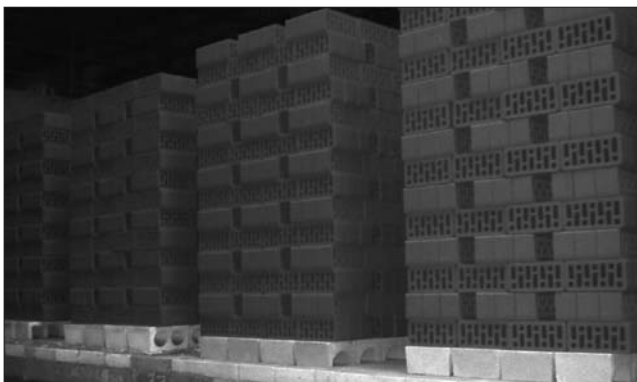
Рис. 4. Стык вагонеток с футеровкой, применявшейся ранее (садка 13 рядов кирпича), и с новой керамобетонной футеровкой (садка 14 рядов кирпича)
