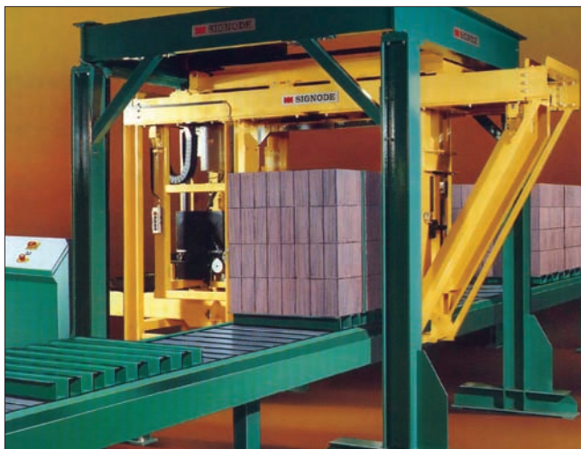
Рис. 3. Установка для обвязки поддона полиэстеровой лентой
