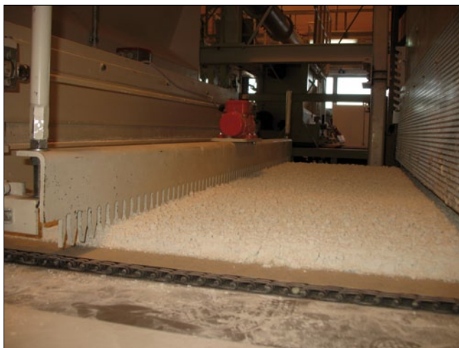
Подача шихты в туннельную печь
