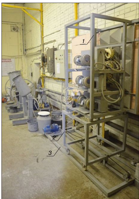
Рис. 3. Опытная стеновая установка «Вертикаль» с СВЧ-нагревателями для прогрева вертикальной поверхности. Технические характеристики: излучающая система на базе резонатора с 6 магнетронами; потребляемая мощность 10 кВт; мощность СВЧ-излучателя 5 кВт; частота излучателя 2450 МГц; 1 – модуль СВЧ-нагрева; 2 – тележка; 3 – направляющая с приводом перемещения тележки
