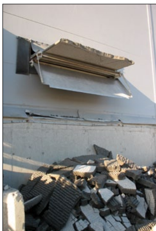
Резкое охлаждение приводит к самопроизвольному распаду пеностеклянного ковра на щебень
