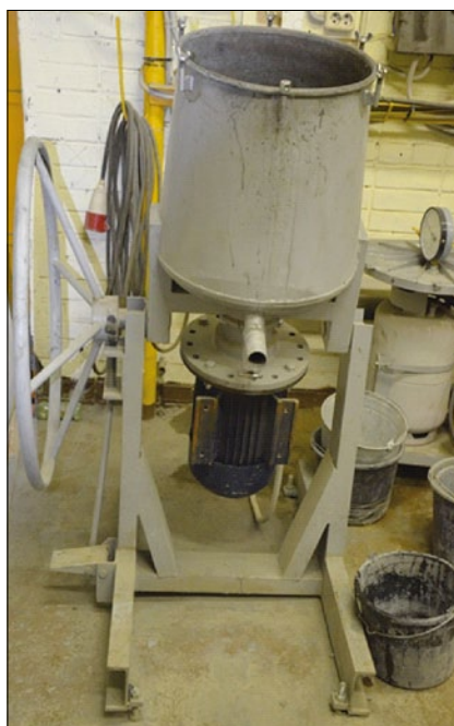
Рис. 4. Лабораторный смеситель с переменной скоростью вращения рабочего органа 0–1000 об/мин, возможностью вакуумирования и выгрузки бетонной смеси с помощью сжатого воздуха
