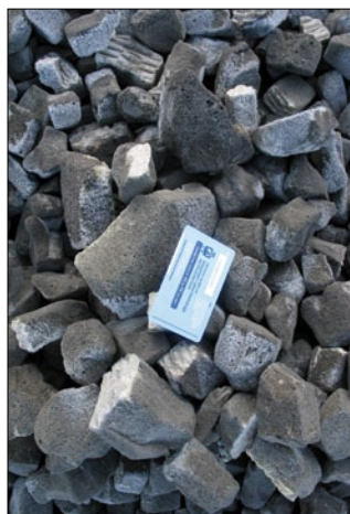
Резкое охлаждение приводит к самопроизвольному распаду пеностеклянного ковра на щебень
