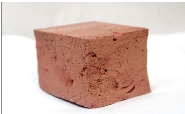
Рис. 1. Теплоизоляционный материал на основе фенольных олигомеров и золы уноса
