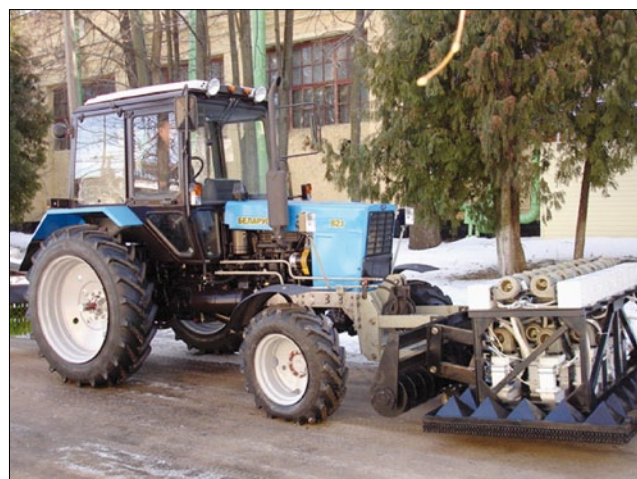
Рис. 2. Опытная мобильная установка с СВЧ-нагревателями для прогрева горизонтальной поверхности. Техническая характеристика: потребляемая мощность 30 кВт; мощность СВЧ-излучателя 20 кВт; частота излучения 2450 МГц; площадь излучателя 1,5–1 м 2
