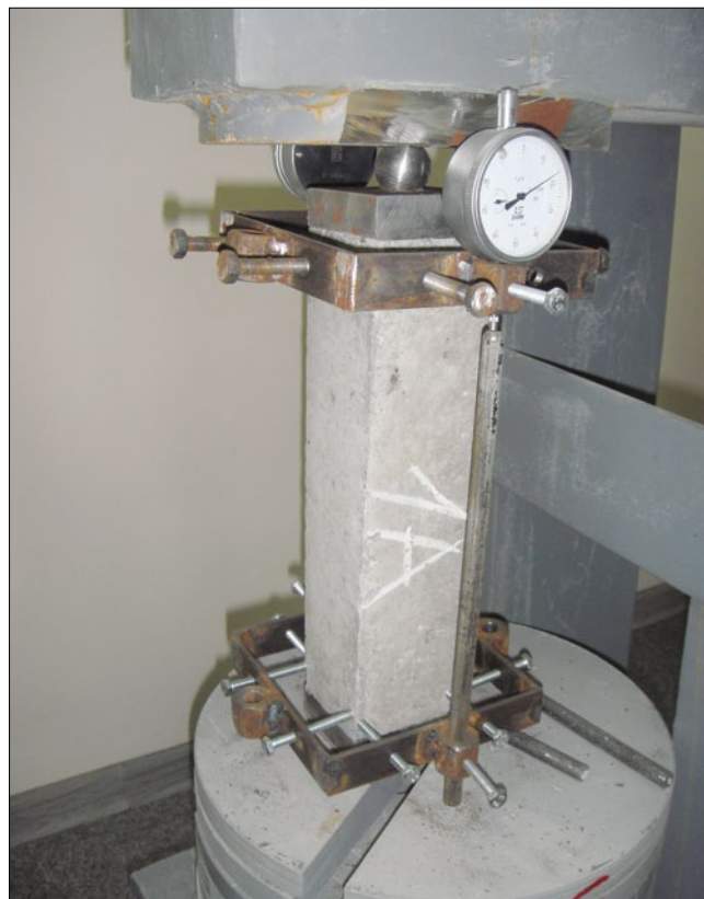
Рис. 2. Образец с металлическими оголовком и шариком для безмоментной передачи нагрузки, подготовленный к испытаниям
