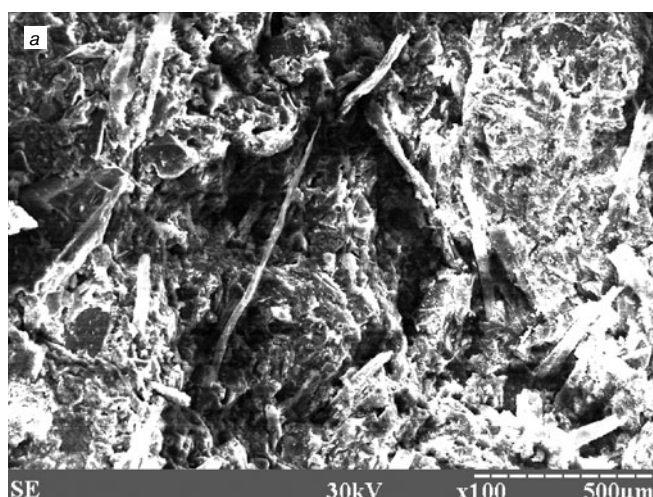
Рис. 4. Электронно-микроскопические снимки скола образцов ФЦП после гидротермальной обработки на основе модифицированного смешанного вяжущего при увеличении \times 100
