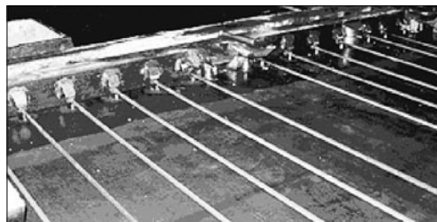
Рис. 6. Форма плиты длиной 6,28 м с напрягаемыми стержнями, натянутыми на внутренние упоры
