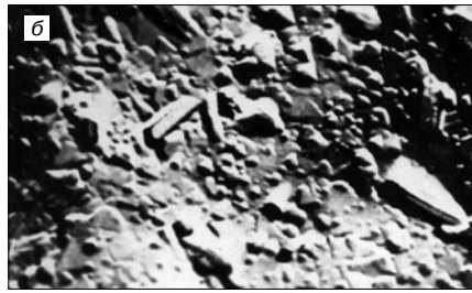
Рис. 6. Образование гематита в кряжском керамзите: а – внутренний слой; б – поверхностный слой
