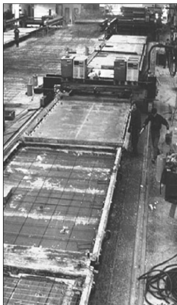
Рис. 4. Стан-конвейер для производства преднапряженных плит с внутренними анкерами
