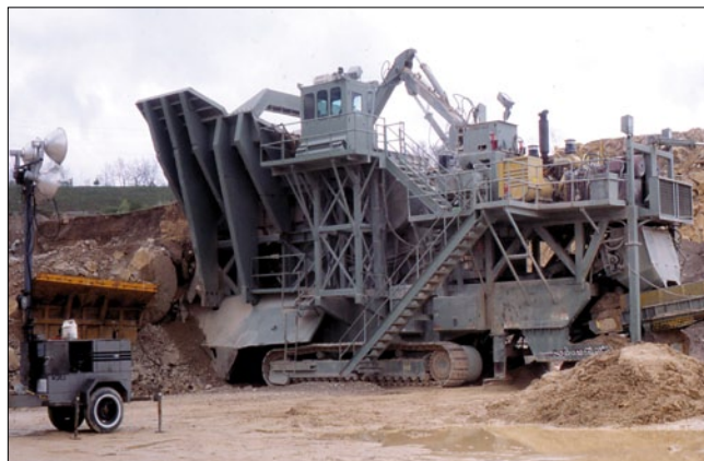
Рис. 2. Самоходный дробильный агрегат на карьере Мраморная Скала (фото автора)
