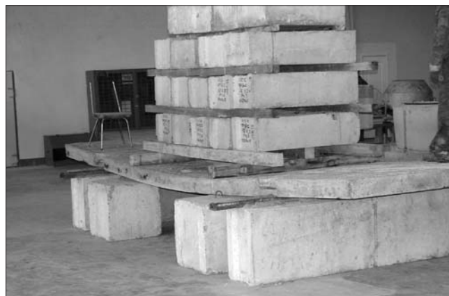
Рис. 2. Испытания керамзитобетонной дорожной плиты под нагрузкой
