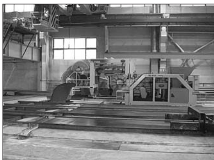
Рис. 2. Формующие агрегаты двух технологических линий (длинных стендов) для формирования конструкций из керамзитобетона с предварительно напрягаемой арматурой
