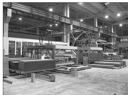
Рис. 3. Отформованные на длинном стенде пазогребневые многопустотные стеновые перегородки из керамзитобетона класса В7,5, марки D1400
