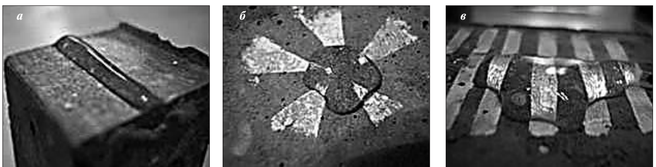
Рис. 2. Возможные конфигурации капли на гидрофильно-гидрофобной поверхности
