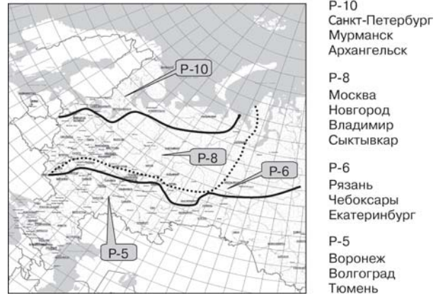
Рис. 4. Схематическая карта зон минимально допустимых толщин асфальтобетонных покрытий, армированных металлической сеткой, и важнейшие города – представители зон. Для зон P-10, P-8, P-6, P-5 минимально допустимая толщина составляет 10, 8, 6, 5 см соответственно
