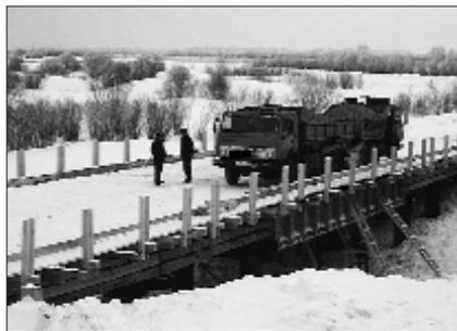
Рис. 2. Испытание статической нагрузкой отдельных несущих элементов конструкции моста
