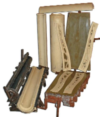
Рис. 2. Формы для получения ППУ-изделий методом заливки
