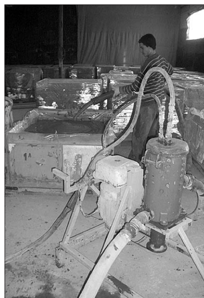
Рис. 3. Фрагмент цеха по производству легкого пенобетона методом «обжиге-релаксация»
