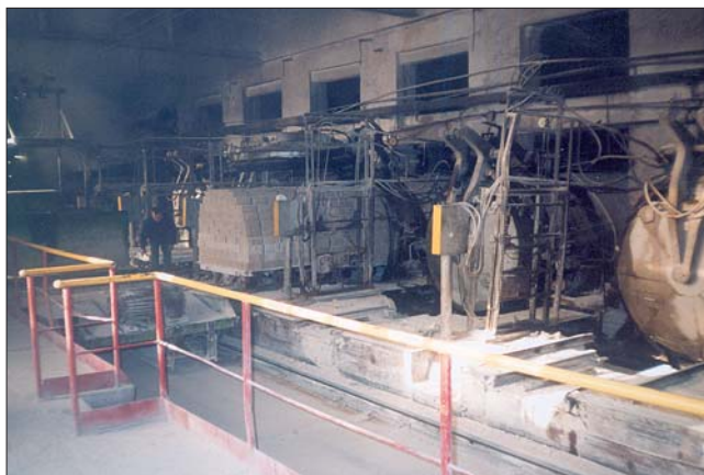
Вагонетки с кирпичом-сырцом направляются в автоклав
