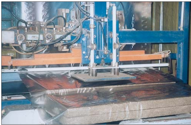
Участок упаковки минераловатных плит
