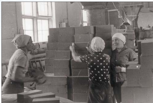
Таким был участок ручной укладки сырца на автоклавную вагонетку
