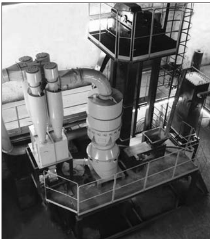
Рис. 3. Измельчительный комплекс КИ-0,63 производительностью 1,5 т/ч
