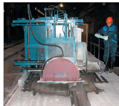
Резка бетонного бруса на изделия производится специальной машиной, оснащенной алмазным инструментом. Возможна резка под углом, что позволяет выпускать изделия произвольной формы
