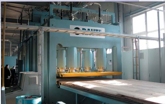
После нанесения клея LVL-полотно попадает под холодный пресс
