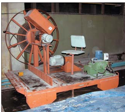
По концам дорожек расположены анкеры, в которые закрепляются концы высокопрочной арматурной проволоки. Специальная машина разматывает ее из бухт и укладывает по всей длине дорожки
