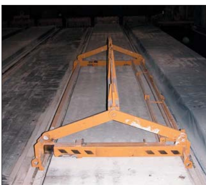
Для снятия плит с дорожки используется специальный захват, который позволяет отказать от монтажных петель. Изделия укладываются на тележку и вывозятся на склад. На стройках применяются аналогичные захваты
