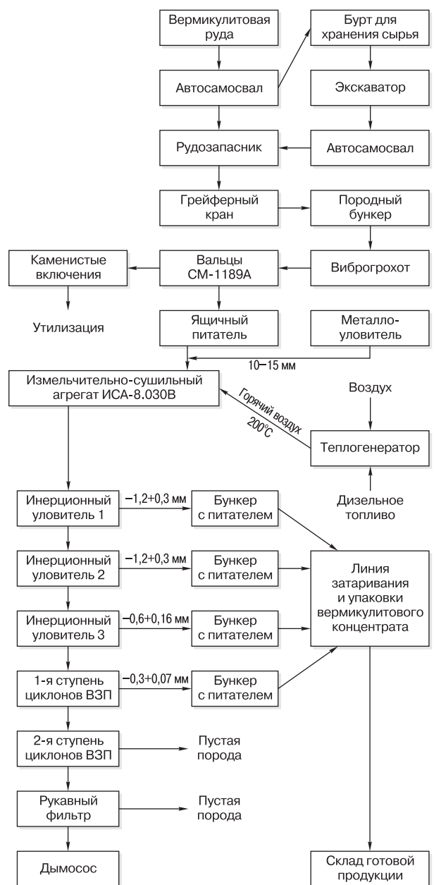
Рис. 1. Технологическая схема производства вермикулитового концентрата
