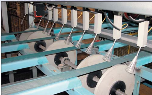
Измерение влажности шпона производится по изменению электропроводности
