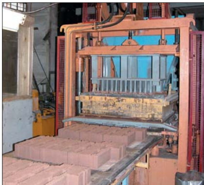
Основным агрегатом технологической линии по выпуску мелкоштучных вибропрессованных изделий «Компакта 600С» производительностью 20 млн шт. усл. кирпича в год является вибропресс Компакта 600, который формирует изделия на деревянных поддонах
