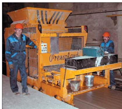
В формовочной машине бетонная смесь, подвергаясь объемной виброобработке, разжижается, проходит между пуансонами прессформы и укладывается на дорожку в виде бруса заданной формы
