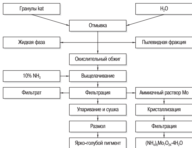
Технологическая схема переработки Mo-Co-Al-kat
