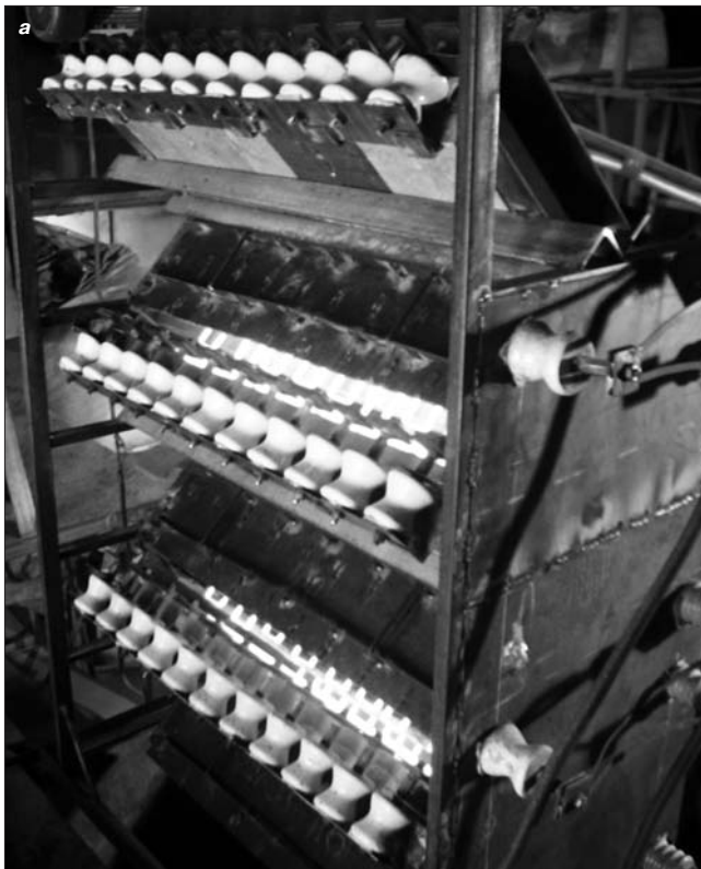
Рис. 4. Шестимодульные печи в процессе испытаний (без кожухов): а – с последовательным сопряжением; б – с последовательно-параллельным сопряжением модулей (ППС)
