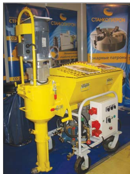
Новинка сезона 2009 г. – штукатурная машина ШМ-30 на стенде завода строительных технологий и машин «Строймашцентр»
