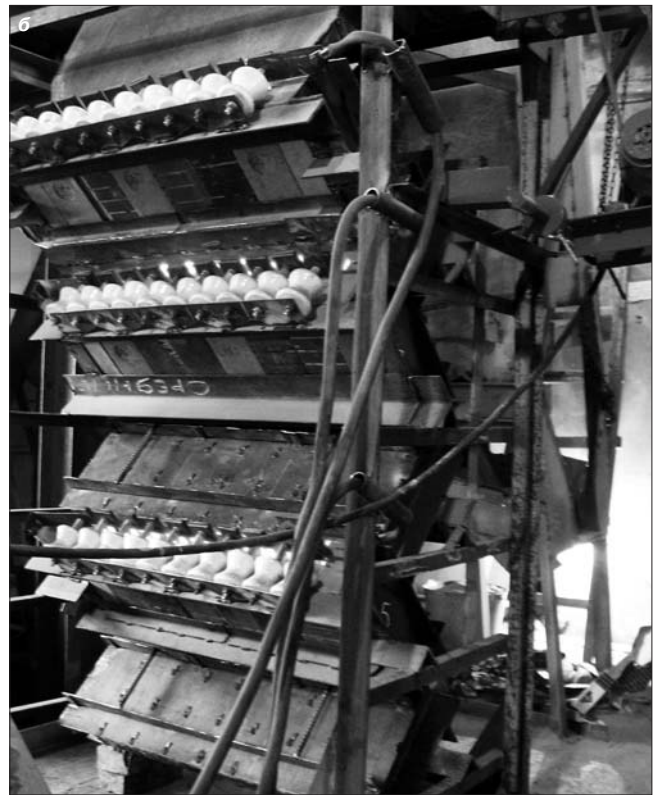
Рис. 4. Шестимодульные печи в процессе испытаний (без кожухов): а – с последовательным сопряжением; б – с последовательно-параллельным сопряжением модулей (ППС)
