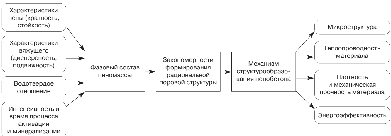
Рис. 1. Схема влияния различных факторов на формирование рациональной поровой структуры
