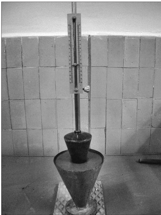
Рис. 1. Определение подвижности раствора на приборе ПГР
