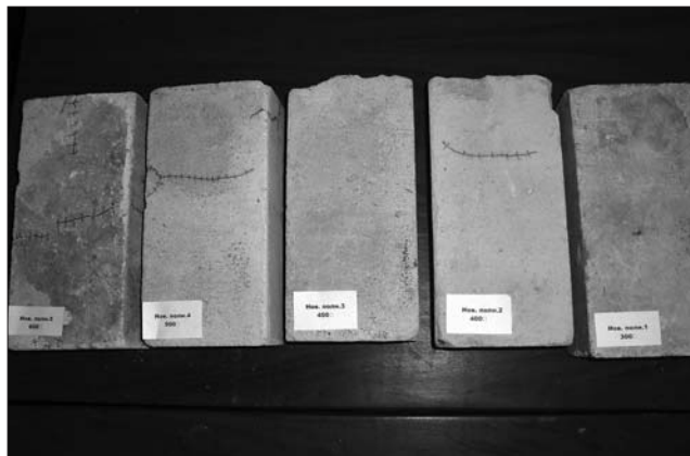
Рис. 2. Характер разрушения образцов
