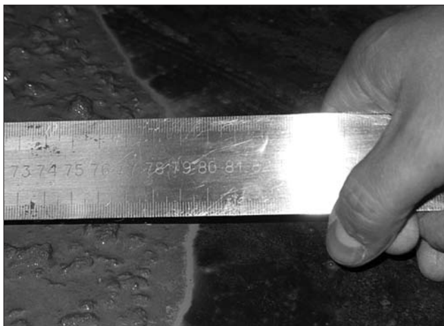
Распływ конуса самоуплотняющейся бетонной смеси
