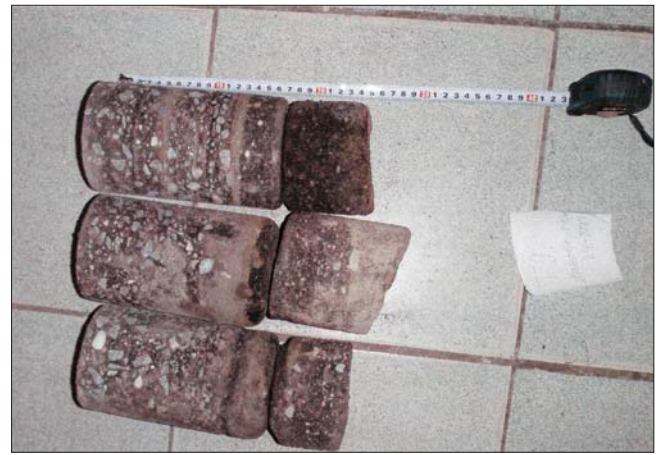
Рис. 6. Керны (монолиты) асфальтобетонных образцов
